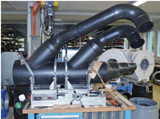
Anspruchsvolle Vorfabrikation im Abwasserbereich
